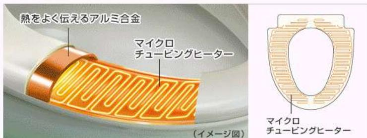
つけっぱなしのムダ※1をなくす、という発想から生まれた世界初※2「新・瞬間あったかトイレ」。トイレに入ると人体センサーで感知して約6秒後※3にはアルミ素材の便座がポカポカ。使用後は1分後に自動的にオフ。使うときだけあたためるので大幅な節電になります。
